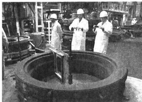
鑄造模型の造型は手作業(遠山鐵工所)
